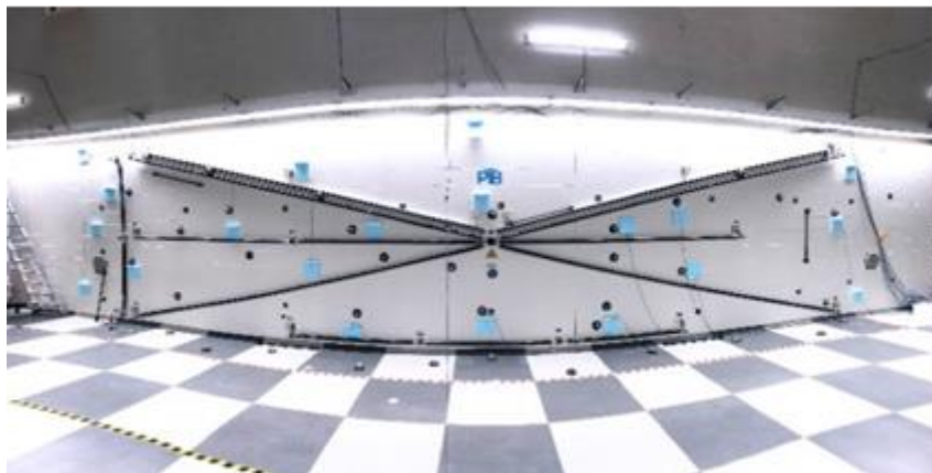
Figura 2. Una fotografía del muro de referencia de PTB con los objetivos y marcadores instalados para el sistema de fotogrametría probado. La longitud máxima es de aproximadamente 12 m (diagonales).
