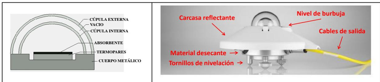
**Figura 4. Partes constituyentes de un piranómetro sobre la fotografía de un piranómetro comercial y detalle de la parte receptora de la radiación solar.**
