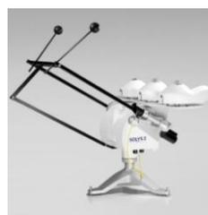
**Figura 6. Medida de la radiación solar difusa. Fotografía de una banda de sombra (izquierda) y de un seguidor solar con dispositivo de sombreado incorporado (derecha).**
