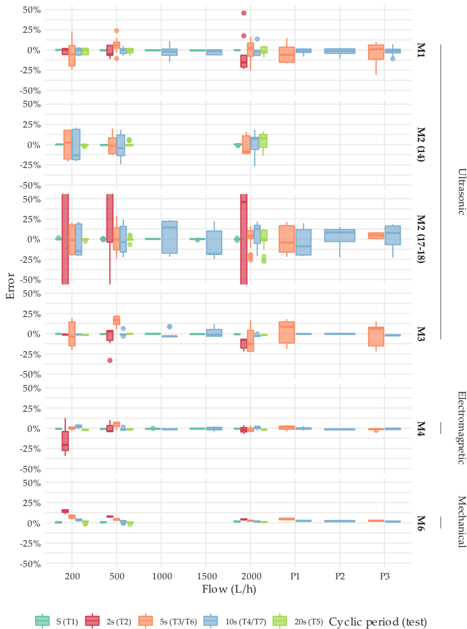
Figura 6: Distribución del error bajo condiciones intermitentes de caudal. Ensayos T2, T3, T4, T5, T6 and T7. DN15. Los resultados T1 se muestran como referencia
