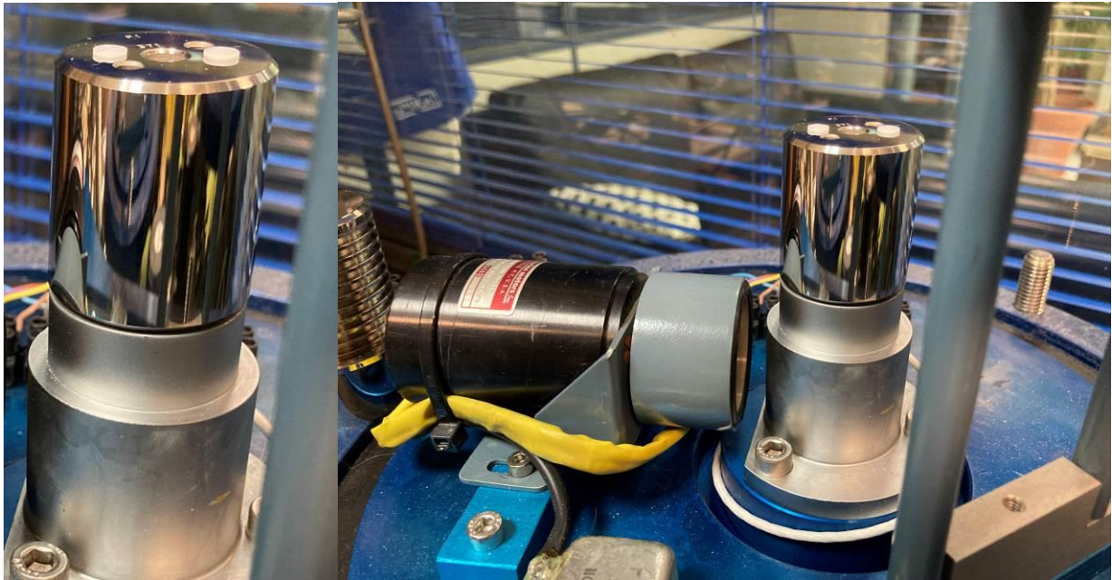
Figura 1: Pistón del conjunto pistón-cilindro P1-371 / C1-353
