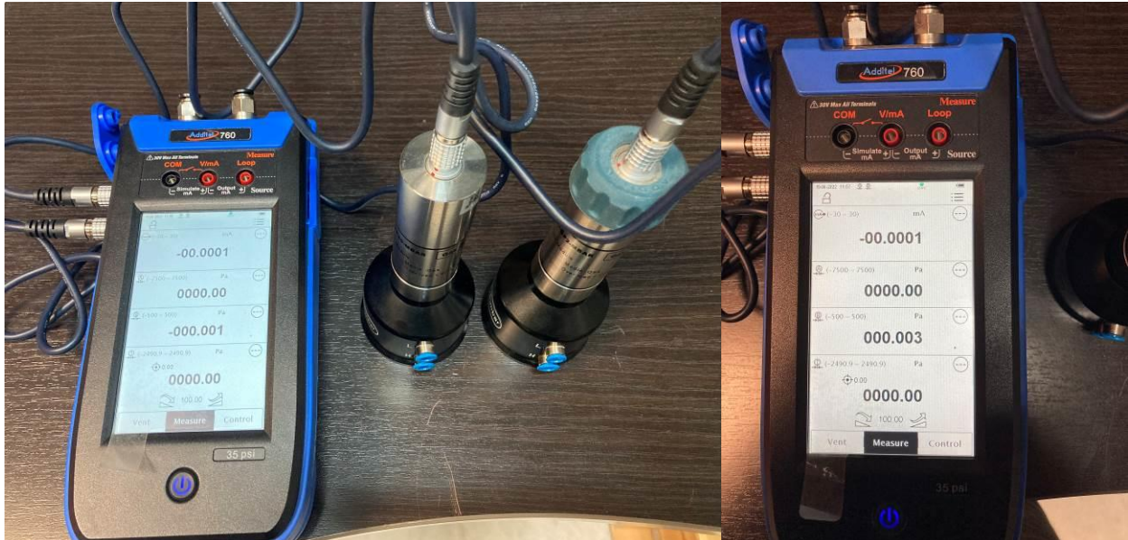
Figura 3: Módulos electrónicos digitales para presiones bajas modo diferencial
