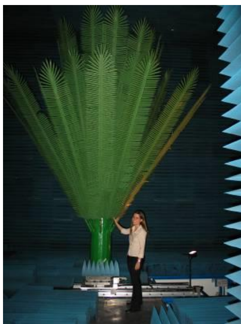
Figura 3: Medida de ocultamiento de antena en sistema plano-cilíndrico.
