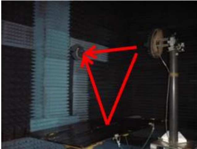
Figura 4: Efecto de la reflexión en una medida y el resultado de su cancelación.
