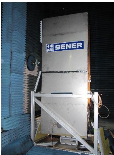
Figura 5: Medida en un sarcófago de la antena de BepiColombo y medidas de diagrama de radiación a 22, 60, 100 y 150°C.
