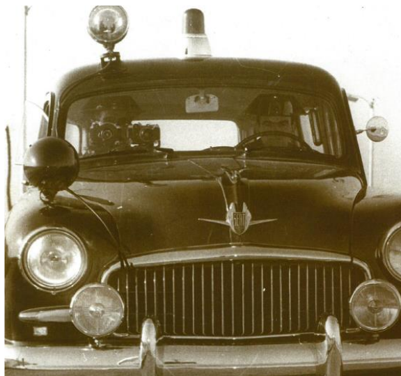
Figura 1. Vehículo dotado de equipo fotocontrol Traffipax 59. [6]
