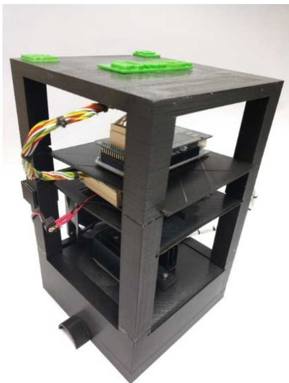
Fig. 1: Foto de SUNBOX. Toda su estructura está impresa en 3D.
