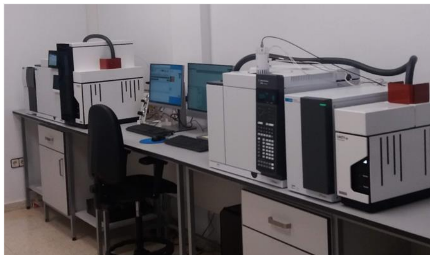
Figura 1. Equipos analíticos TD-GC-MSD y TD-GC-NCD
