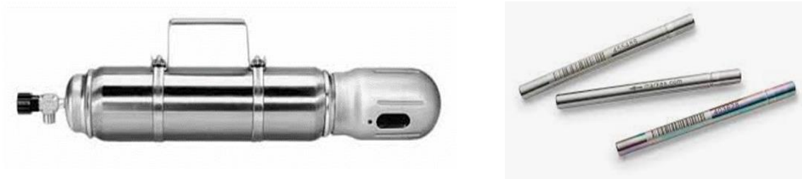
Figura 2. Cilindros y tubos de captación para la toma de muestra
