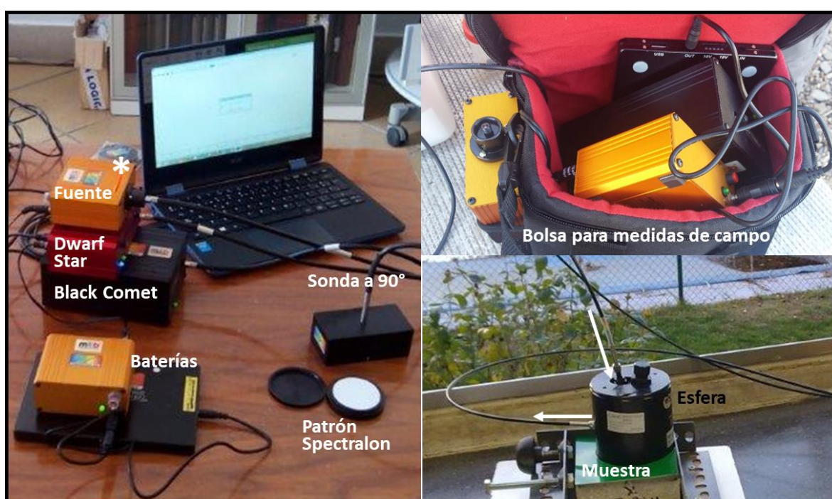
Figura 1 – Equipamiento portátil disponible para la medida in-situ de la reflectancia solar y la emisividad de materiales urbanos.
