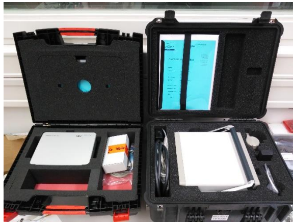
Fig. 4. Sistema de medida empleado en caracterización de cámaras climáticas
