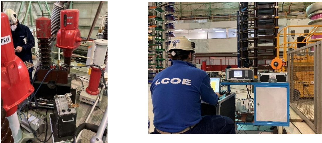
Fig. 3. Calibración “in situ” de transformadores de intensidad en un laboratorio de alta tensión.
