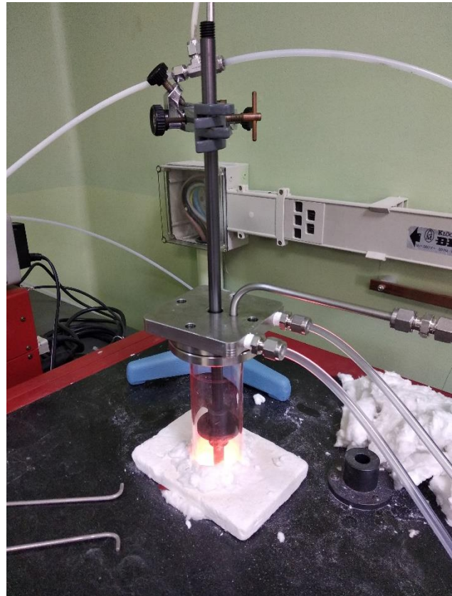
Figura 1. Esquema y foto del sistema de llenado de puntos fijos de alta temperatura del CEM.
