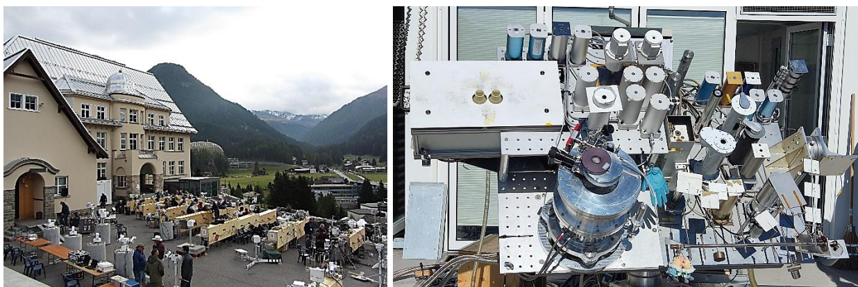
Fig. 1. Izquierda: imagen de la International Pyrheliometer Comparison IPC-XII (2015) organizada en el centro PMOD/WRC (Davos, Suiza); Derecha: el grupo mundial de patrones WSG emplazados en su seguidor solar junto a otros sensores de irradiancia solar.
