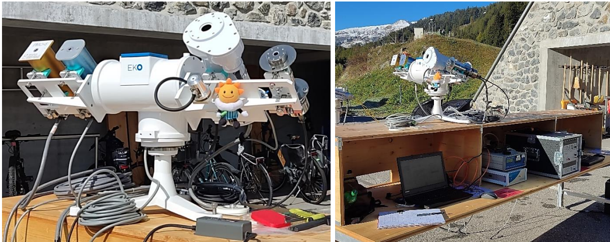
Fig. 2. Radiómetros solares de cavidad del CIEMAT durante la última intercomparación IPC-XIII (2021) en el PMOD/WRC (Davos, Suiza), montados sobre el seguidor solar a dos ejes.
