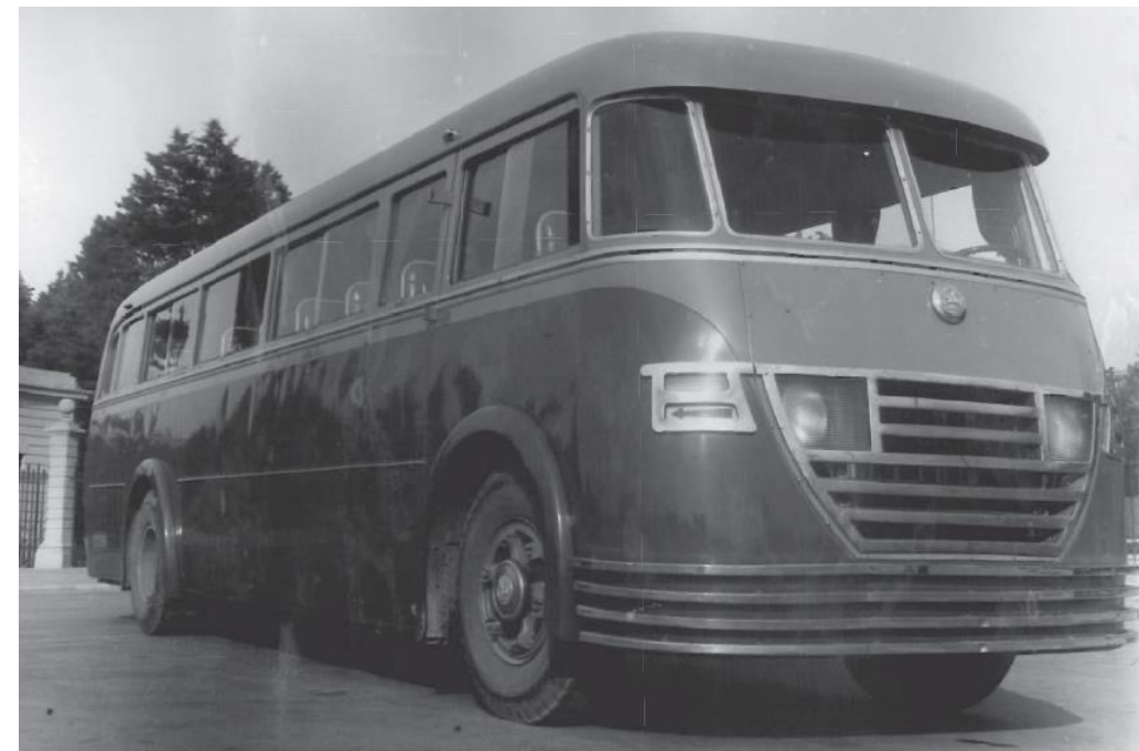
Autobús a partir del bastidor del Pegaso II
