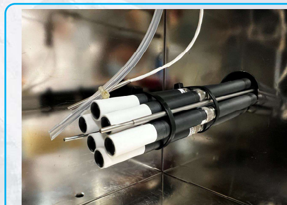
Fig. 1 Calibración en lotes de sensores de Temperatura y Humedad.
