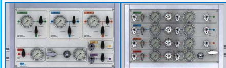
Figura 6 (izquierda): Frontal del sistema neumático de medida, que permite, mediante válvulas, conectar al sistema neumático balanzas, controladores, equipos a calibrar, o bombas de vacío.
