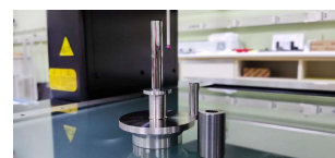
Figura 1. Conjunto pistón-cilindro patrón de presión
