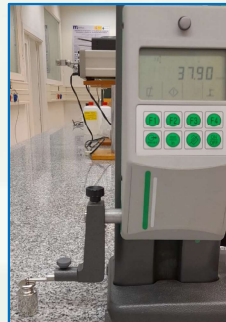
Figura 5: Foto del montaje columna de alturas. La pesa se sitúa sobre una superficie horizontal y lisa, como una mesa de granito y el palpador se apoya sobre la superficie de la pesa.
