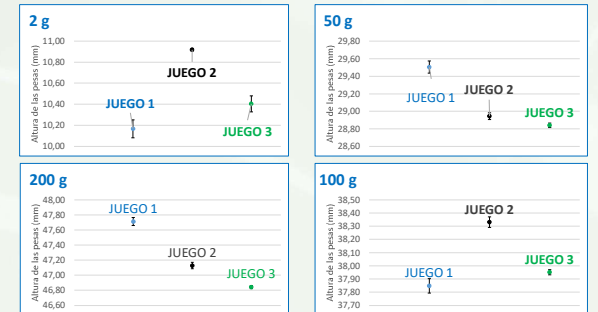
Gráficos 1, 2, 3 y 4 (de izquierda a derecha y de arriba abajo): Determinación de alturas para las distintas pesas mencionadas en la Tabla 3. Las barras de error reflejan la incertidumbre de medida, que tiene en cuenta la resolución y una contribución por repetibilidad. Cada pesa tiene un valor característico de alturas, y el montaje cuenta con la suficiente precisión (inferior a 0,1 mm) para distinguir una pesa de otra. Las alturas se muestran en mm.
