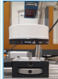
Figura 4: Foto del montaje con láser en el que se mide la altura de una pesa de 2 g. Entre el láser y la pesa, se sitúa un filtro que disminuye la intensidad de luz reflejada.
