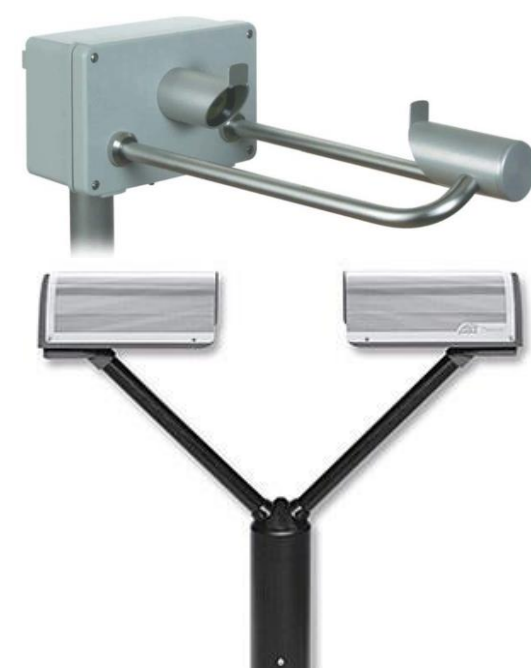
Equipos utilizados en el CEM: Thies Climate Laser Precipitation Monitor, cortesía de AEMET, y OTT Parsivel2.
