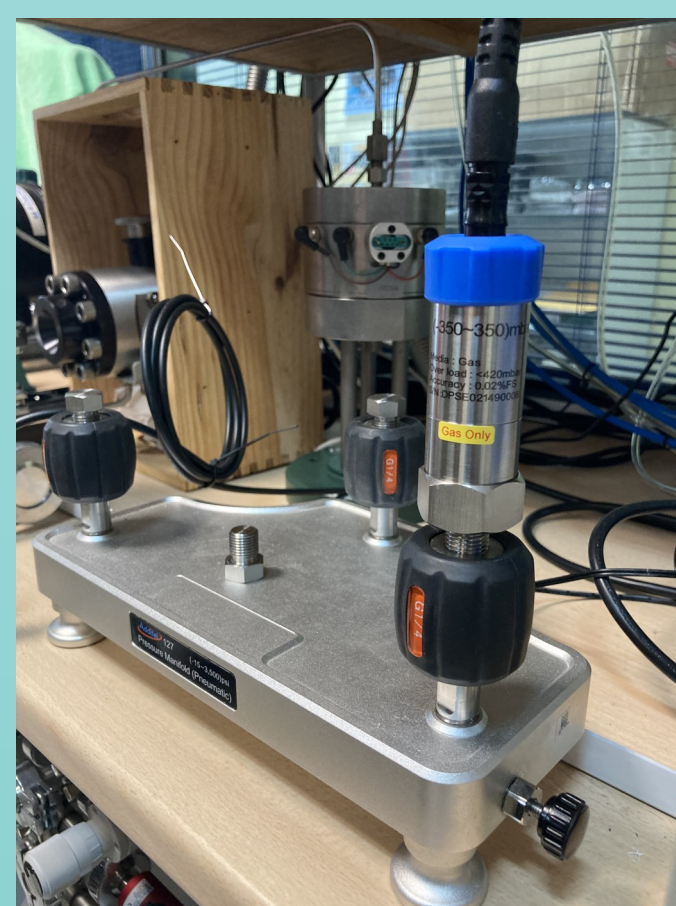
Fig. 4: Módulo de presión ADT161 con terminal visualizador digital.
